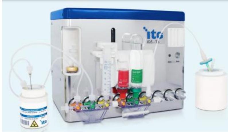
图 3.2-12 使用合成模块制备  $^{177}\text{Lu}$ -DOTATATE 的示意图
